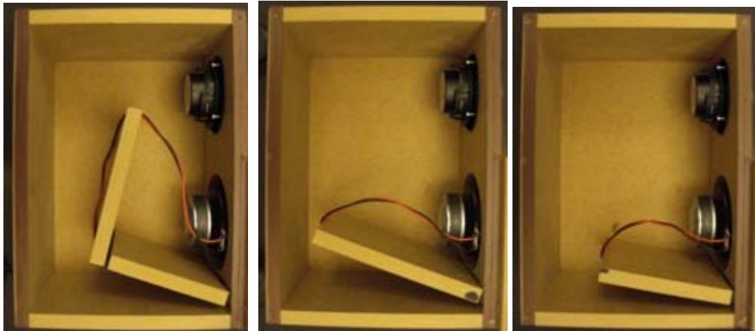
Bild 2.10 Ausführungen des Bassreflexkanals.
